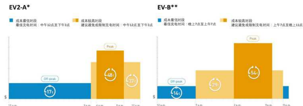
图 11 美国加州 PG&E 电力公司的电动汽车充电分时电价
