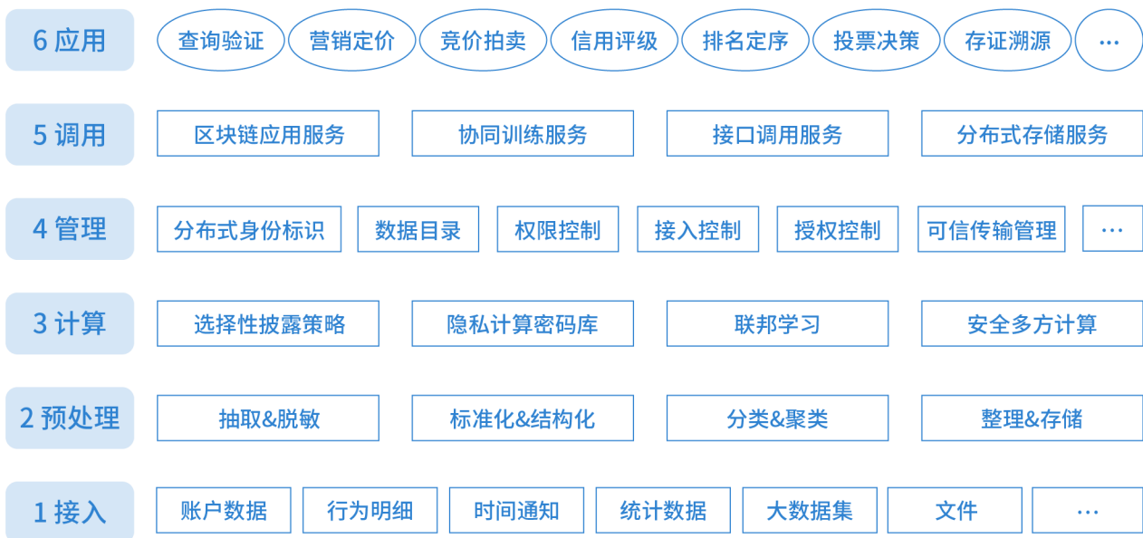
图 7 微众银行数据协同生产的全栈技术架构
