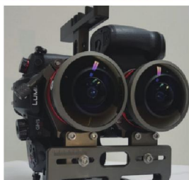
180° VR摄像机 (由2台摄像机+2个鱼镜头组合) (来源: 我趣网)
